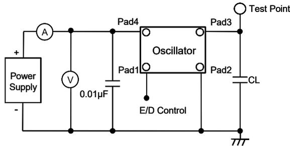
Note: CL最大負荷(測定治具及びプローブ容量を含む)
