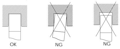
検査工程等で FPC/FFC の挿抜を行う際は、最終組み込み用 FPC/FFC よりも薄い FPC/FFC を使用願います。
