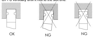
多極で使用されます FPC/FFC によっては挿入の際にコネクタに傷をつけてしまう恐れがあります。FPC/FFC をご提供いただければ、弊社にて確認させていただきますので御相談下さい。
