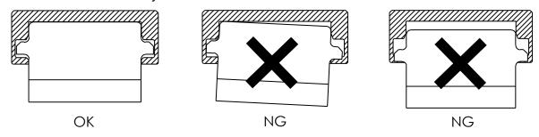
多極で使用されます FPC/FFC によっては挿入の際にコネクタに傷をつけてしまう恐れがあります。FPC/FFC をご提供いただければ、弊社にて確認させていただきますので御相談下さい。
