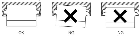
検査工程等で FPC/FFC の挿抜を行う際は、最終組込み用 FPC/FFC よりも薄い FPC/FFC を使用願います。 For the FPC/FFC insertion and separation in the inspection process, please use thinner FPC/FFC than those for final assembling.
