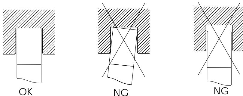
検査工程等で FPC の挿抜を行う際は、最終組み込み用 FPC よりも薄い FPC を使用願います。
