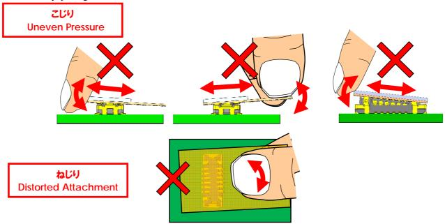
万が一こじり抜去を行う必要がある場合は、長手方向に行って下さい。但し、長手方向への作業は、こじる側の実装基板・FPC 厚みにより、コネクタが山反り方向に変形、または、破損する場合があります。事前にご確認の上、作業を行って下さい。
