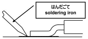
(7) PLUG 側は接点が外側に露出している為、実装の際はフラックスの飛散に ご注意お願い致します。 In the mounting process, special care is needed so that the exposed contact points on the plug side will be free from splattered flux.
