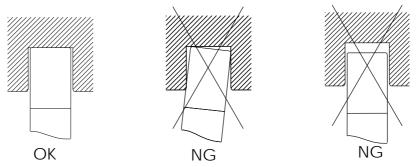
検査工程等で FPC/FFC の挿抜を行う際は、最終組込み用 FPC/FFC よりも薄い FPC/FFC を使用願います。 For the FPC/FFC insertion and separation in the inspection process, please use thinner FPC/FFC than those for final assembling.
