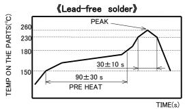
(4)  $N_2$ リフローによるはんだ付けは、 $O_2$  濃度が 1000ppm 程度で下記に示す弊社リフロー温度プロファイル条件での実施を推奨致します。なお、リフローは 2 回以下を推奨します。
