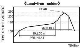
(4) N<sub>2</sub>リフローによるはんだ付けは、O<sub>2</sub> 濃度が 1000ppm 程度で下記に示す弊社リフロー温度プロファイル条件での実施を推奨致します。なお、リフローは 2 回以下を推奨します。
