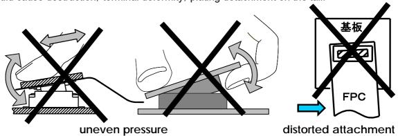
(3) 嵌合は位置合わせを行った上で、Plug 側、Rec.側の両方が平行になる状態で行って下さい。 なお、嵌合位置合わせは、過度な力を加えずに行って下さい。過度な力を加えた場合、成形品の破壊等、発生する場合があります。
