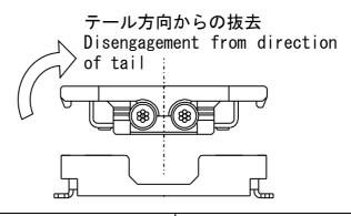
(3) 嵌合を外す際(抜去時)には電線を無理に引っ張らないでください。 また、先の尖ったもので、無理に嵌合を外すことはコネクタを破損させ る原因となりますので、挿入抜去冶具の使用を推奨します。
