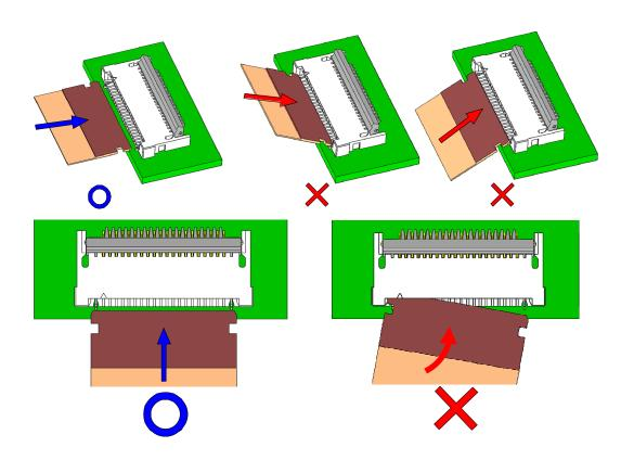
FPC は基板に対して水平方向にカードスロットの最奥部に当たるまで挿入して下さい。 Please insert a FPC into the slot end connector horizontally against the board.
