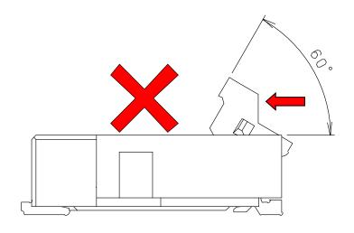
※アクチュエータを開放する際、下図のアクチュエータの中央を左右均等に荷重が掛かった状態で真上 に上げる様に操作してください。片側に荷重を掛けた状態で開放しないよう注意願います。
