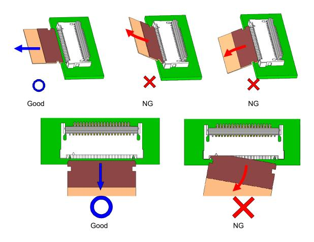
※アクチュエータ開放角度は 60° までを目安とし、さらに開く方向への荷重を加えないようにしてください。
