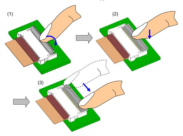
※アクチュエータをロックする際、下図のアクチュエータの中央を左右均等に荷重が掛かった状態で操作してください。片側に荷重を掛けた状態でロックしないよう注意願います。
