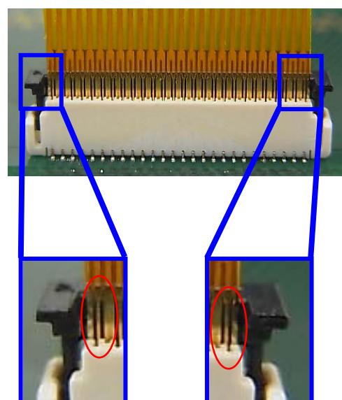
(3)「スライダー」をロックする Close and lock the slider.
