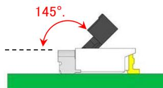
アクチュエータは回転させるように操作してください。開放角度は145°を目安として、過剰開放しないようお願いします。
