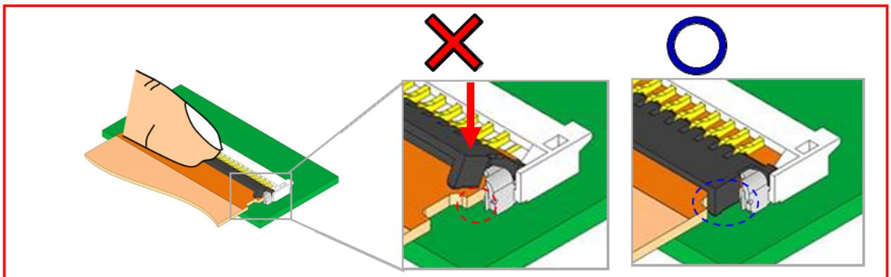
※FPC/FFC がしっかりと挿入されていない状態で無理にロックしないでください。破損、変形の原因となります。
