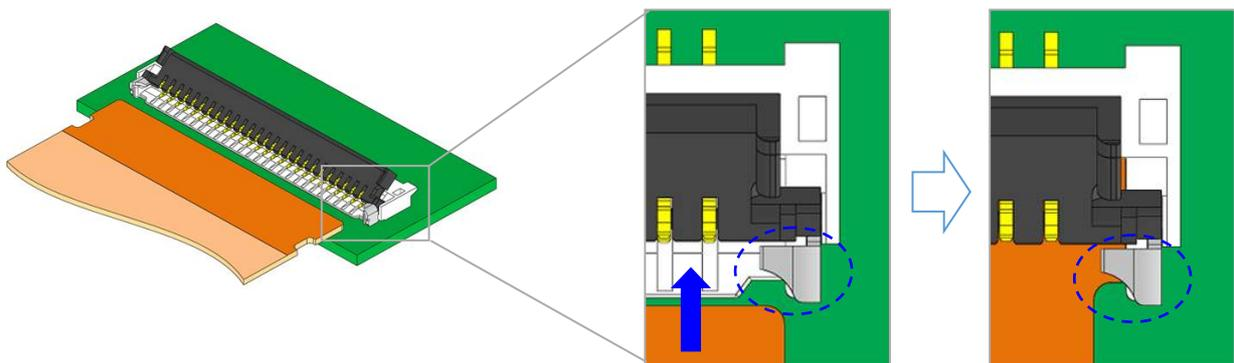
コネクタの両端に金具ガイドがありますので、FPC は金具ガイドの下から水平に挿入をしてください。
