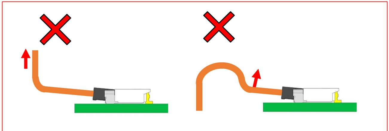
※導通切れ、コネクタ破損の懸念がありますので FPC/FFC を上方向へ負荷がかかるような引き回しはしないようお願いいたします。
