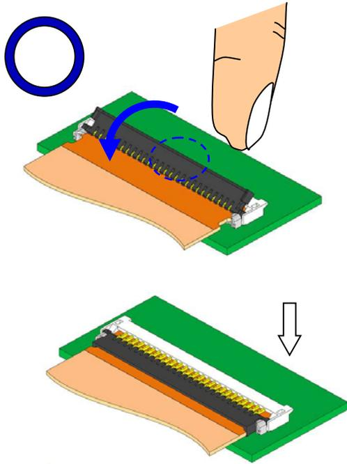
回転させるようにアクチュエータ中央部に軽く荷重を加え、ロックさせます。挿入した FPC/FFC が斜めになっていないか確認した上でロックさせて下さい。
