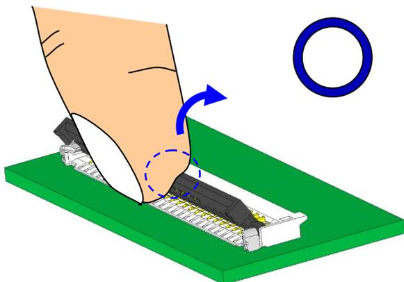
アクチュエータの中央部を操作し上方向に押し上げます。
