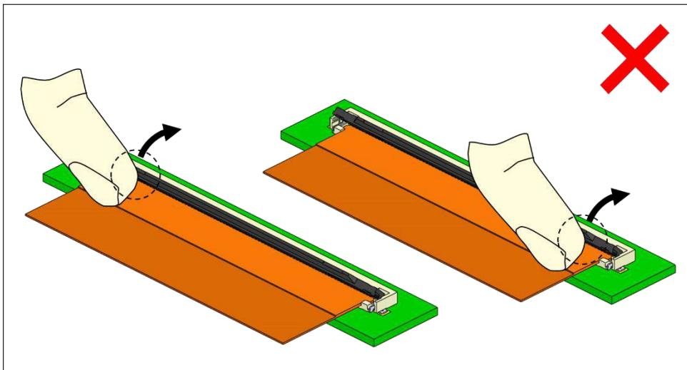
アクチュエータロック状態でFPC/FFCを引き抜かないでください。コネクタあるいはFPC/FFCが破損する恐れがあります。
