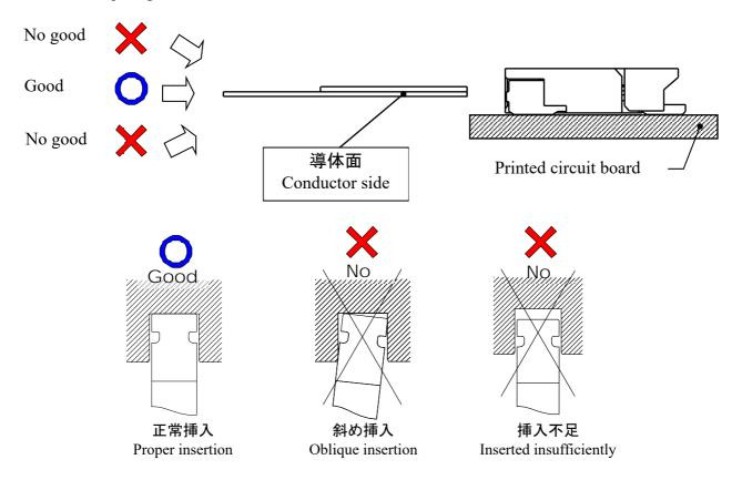
(3) スライダーをロックさせて下さい。挿入した FPC が斜めになっていないか確認した上、スライダーを回転軸方向に軽く荷重を加えつつ押し下げ、ロックさせてください。
