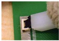
(3) 治具を接地させたまま寝かし、 スライダーを開放する。Recline the jig with its bottom grounded.
