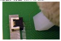
(1) 治具をスライダーに当てる。 Apply the jig to the actuator.
