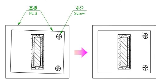
(2) コネクターが基板に対してセンターに実装されない場合、もしくは大きい基板同士の嵌合の場合に 嵌合が傾く恐れがありますので、下図のような傾き防止用のスペーサーおよび嵌合方向への押さえ による固定をお勧めします。
