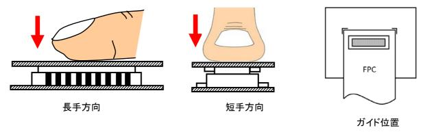
(3) 離脱時、各基板を平行に維持しながら離脱することを推奨します。 When detaching, it is recommended to detach while keeping each board parallel.
