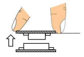
(4) 本製品は小型、軽量化をする為に成形品の肉厚を薄くしており、嵌合・離脱時に過度なこじり、ねじり挿抜 は成形品の破壊、端子の変形、テール部はんだ剥離の原因となりますので、ご注意をお願い致します。 We minimized the thickness of this product to achieve downsizing and light weightiness. Because of this, uneven pressure or distorted attachment at Insertion / separation could cause destruction, terminal deformity, plating detachment on the tail.
