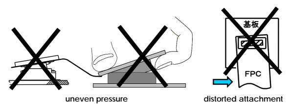
(5) 嵌合は位置合わせを行った上で、Plug 側、Rec.側の両方が平行になる状態で行って下さい。 なお、嵌合位置合わせは、過度な力を加えずに行って下さい。過度な力を加えた場合、成形品の破壊等、 発生する場合があります。
