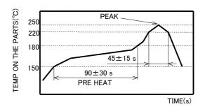
(4)  $N_2$  リフローによるはんだ付けは、 $O_2$  濃度が 1000ppm 程度で下記に示す弊社リフロー温度プロファイル 条件での実施を推奨致します。なお、リフローは 2 回以下を推奨します。(Solder: Sn-3Ag-0.5Cu) For the soldering through  $N_2$  reflow, please apply our recommended temperature and profile condition as the chart below under the condition of 1000 ppm of  $O_2$  level. And, the reflow recommend 2 times or less. (Solder: Sn-3Ag-0.5Cu)
