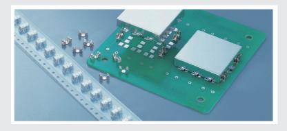
デジタルメディア製品の機器内部に使用されているシールドケースを 固定するために開発された小型端子です。この製品を使用すること により、従来手付け半田により行われていたシールドケースの取付け 作業が、ワンタッチで行うことが可能となります。
