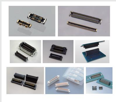
京セラの基板対基板コネクタは、スマートフォンやウェアラブルデバ イスなどの小型機器に最適な 0.35mm ピッチの狭ピッチ・低背・ 省スペース製品から、自動車や医療機器など高い接触信頼性を 要求される機器に最適な基板実装のズレや振動を吸収するフロー ティング構造を採用した製品など豊富なバリエーションを取り揃えて います。 振動や落下衝撃に強い独自の「挟み込み接点形状」 (2点接点)や集中荷重を上げて異物を排除(ワイピング効果) する機構など高い接触信頼性を実現したシリーズも準備しています。
